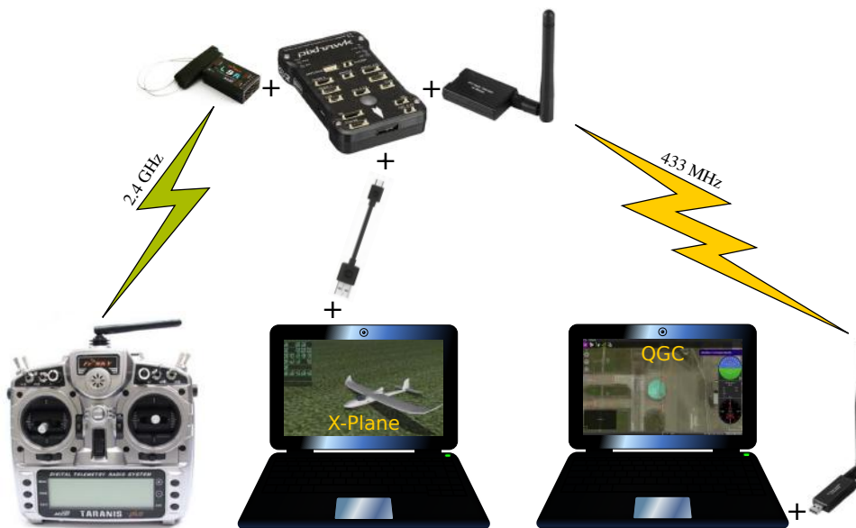
Figura 9 – Esquema da arquitetura de simulação HITL montada.
