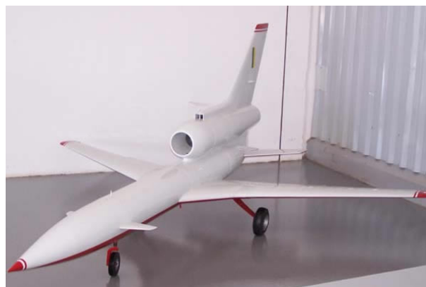
Figura 2.1: Veículo aéreo não tripulado BQM-1BR. Foto: Rodrigo Zanette.
